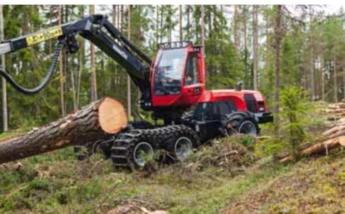
Уникальная гидросистема с 3 насосами позволяет одновременно задействовать несколько функций, – например, поворачивать манипулятор, протягивать ствол и перемещать машину без ущерба для гидравлической мощности.
