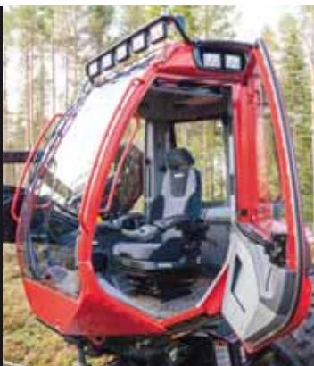
В новой просторной, шумоизолированной кабине увеличены окна, обеспечивая идеальную обзорность вперед-вниз, вперед-вверх и назад.
